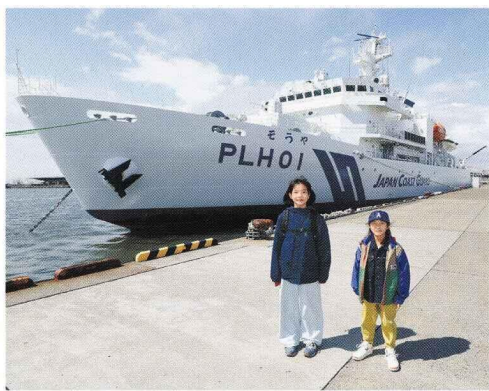
そうやを見学した2人。船の前は氷をくだくため丸みがあります。船に書かれた「PLH01」は船の型番です
